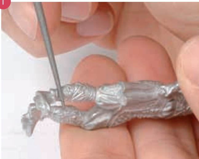
Limado de las líneas de molde con una lima redonda.
