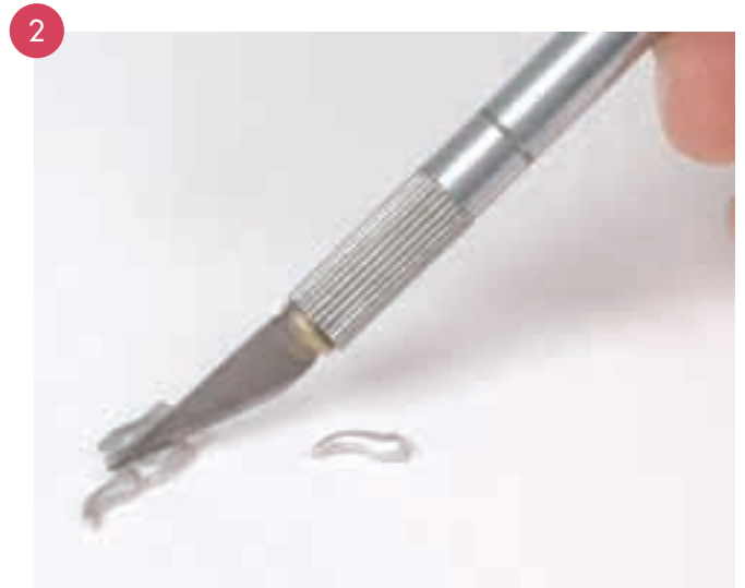
Cortamos con cuidado las piezas que se encuentran unidas al bastidor de metal.
